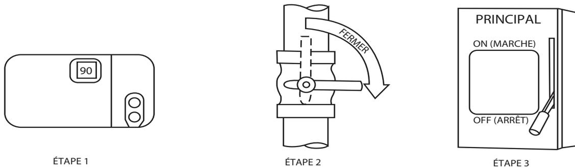
Fig. 7 – Pour couper la climatisation électrique
