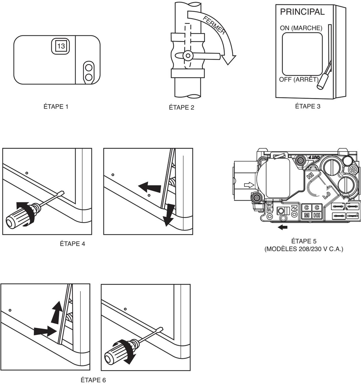
Fig. 5 – Pour démarrer l'appareil de climatisation électrique
