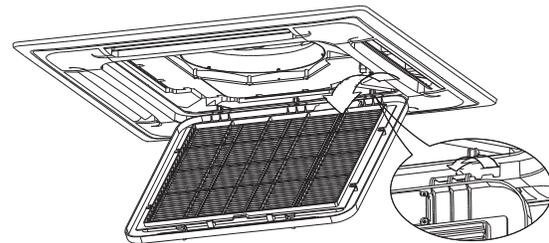
Fig. 11 - Retirer le filtre
