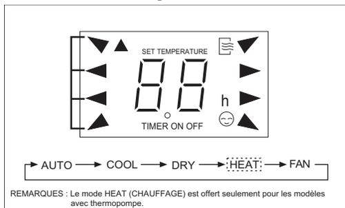
Fig. 7 - Sélectionner un mode de fonctionnement
