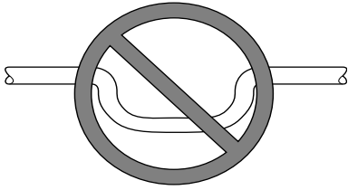
NE PAS UTILISER DE SIPHON CONSTITUÉ D'UN CONDUIT ÉTROIT!
