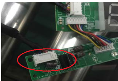
Figure 17 — CN201 est la connexion à la carte-mère principale
