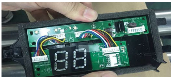
Figure 21 — Panneau d’affichage installé sur le support de panneau d’affichage
