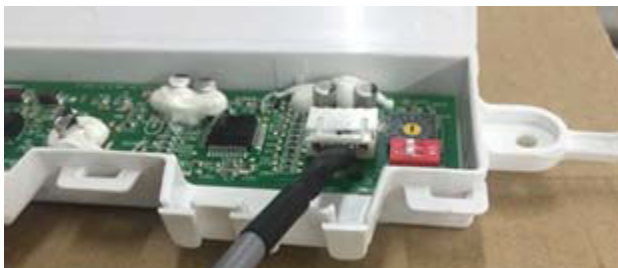
Figure 23 — Raccordement entre module adaptateur et panneau d’affichage
