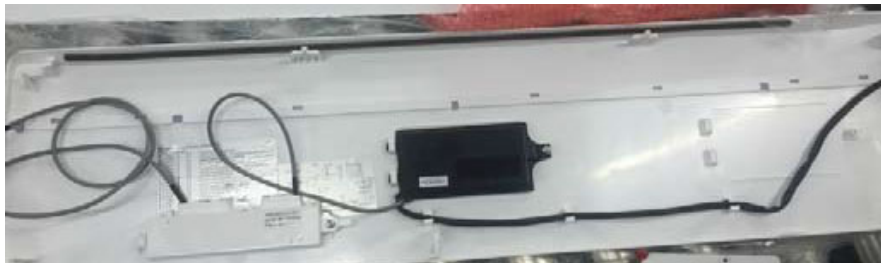
Figure 26 — Panneau avant avec nouveau panneau d’affichage et nouveau module adaptateur
