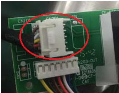
Figure 18 — CN101 est la connexion au module adaptateur
