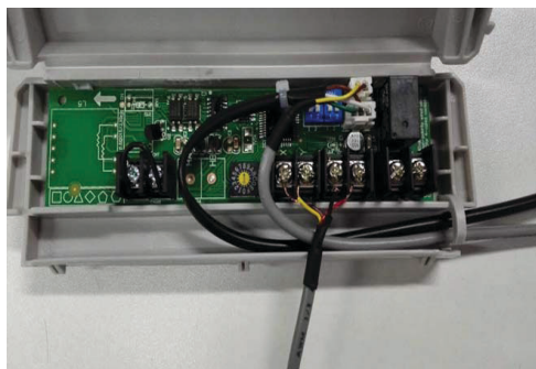
Fig. 30 – Branchement du câble à la carte
