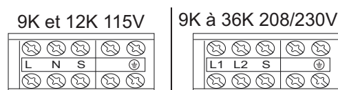
Fig. 14 — Commande et câblage électrique du module intérieur
