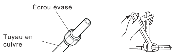
Fig. 19 — Serrez l'écrou évasé
