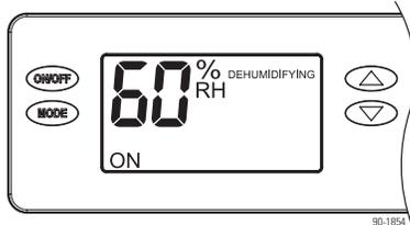
Si le taux d'humidité dans l'air est supérieur à celui du réglage, le compresseur se met en marche et le régulateur affiche DEHUMIDIFYING (déshumidification) sur son écran, en plus de l'humidité mesurée.
