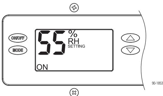
Les flèches vers le HAUT et le BAS permettent de régler le taux d'humidité de 40 % à 80 % d'humidité relative. Appuyez sur la touche ON/OFF (marche/arrêt) pour mettre le déshumidificateur en marche ou l'arrêter.
