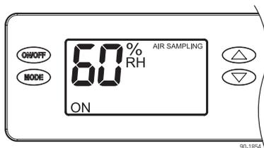
Lorsque le déshumidificateur se met en marche, le ventilateur fait circuler l'air pendant trois minutes avant de mesurer le taux d'humidité dans l'air. Le régulateur intégré affiche AIR SAMPLING (échantillonnage de l'air) sur son écran, en plus de la valeur du taux d'humidité mesuré.
