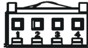
Fig. 20: Diseño de las clavijas del mazo de cables del sensor
