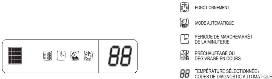
**Fig. 4 – Affichage des modèles 40MKCB28B, 40MKCB32B, 40MKQB24B et 40MKQB28B**
