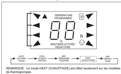
Fig. 9 – Sélectionner un mode de fonctionnement
