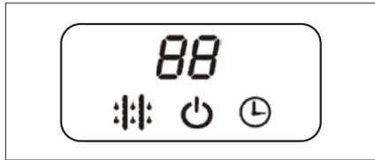
**88** Indicateur SELECTED TEMPERATURE (TEMPÉRATURE SÉLECTIONNÉE)/ SELF-DIAGNOSTIC CODES (CODES DE DIAGNOSTIC AUTOMATIQUE)
