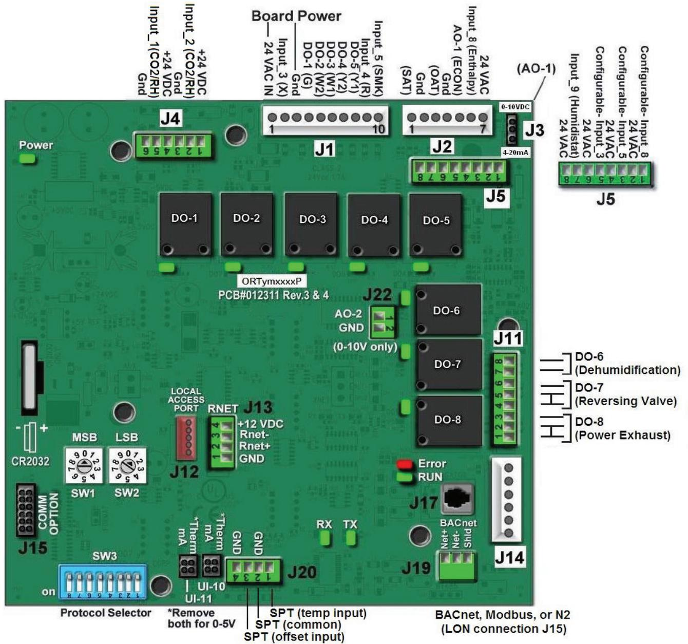
Fig. 51 - RTU-OPEN Control Module
