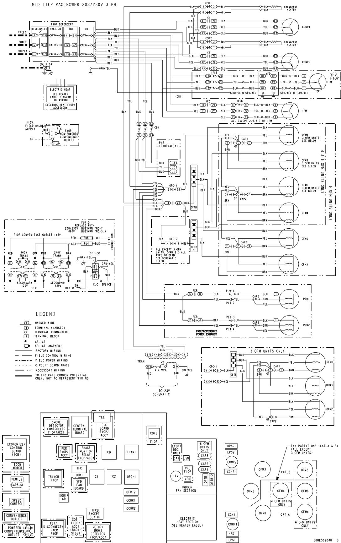
Fig. 54 - 50TCQ-D24 Power Wiring Diagram; 208/230-3-60
