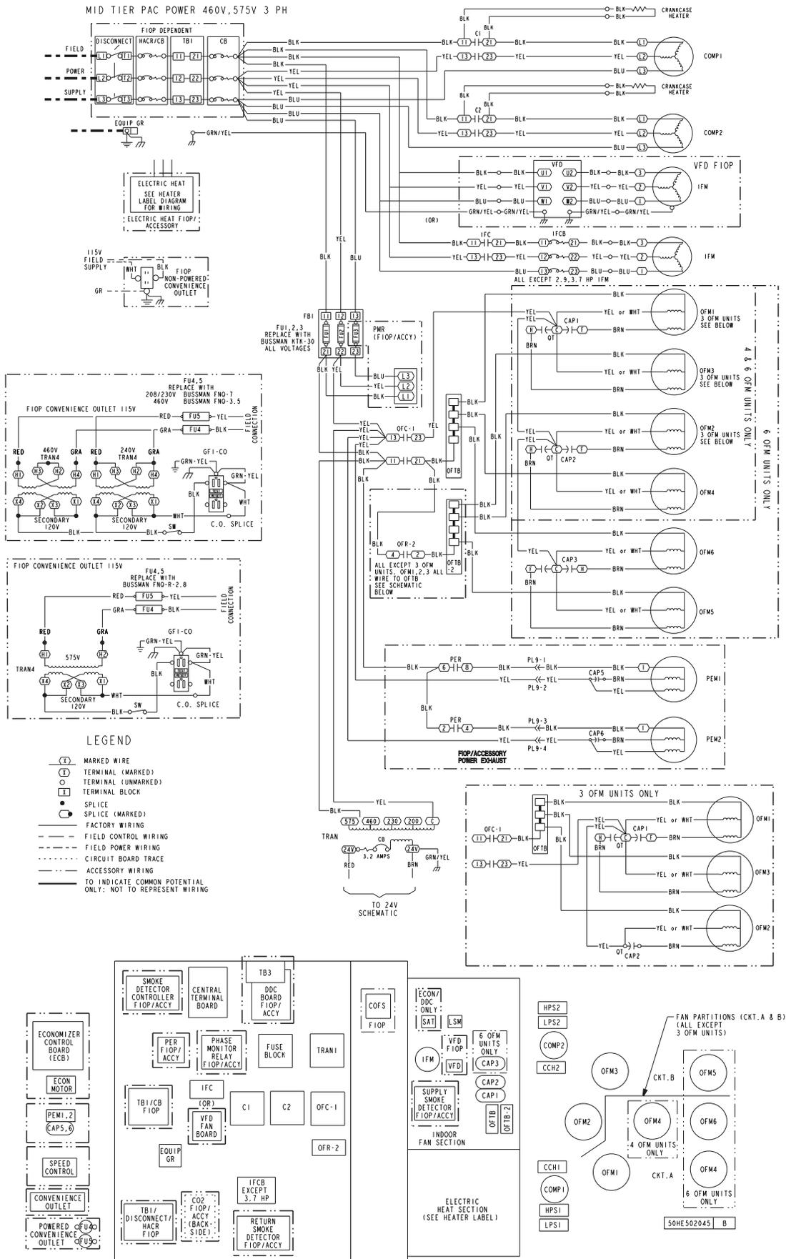
**Fig. 55 - 50TCQ-D24 Power Wiring Diagram; 460-3-60/575-3-60**
