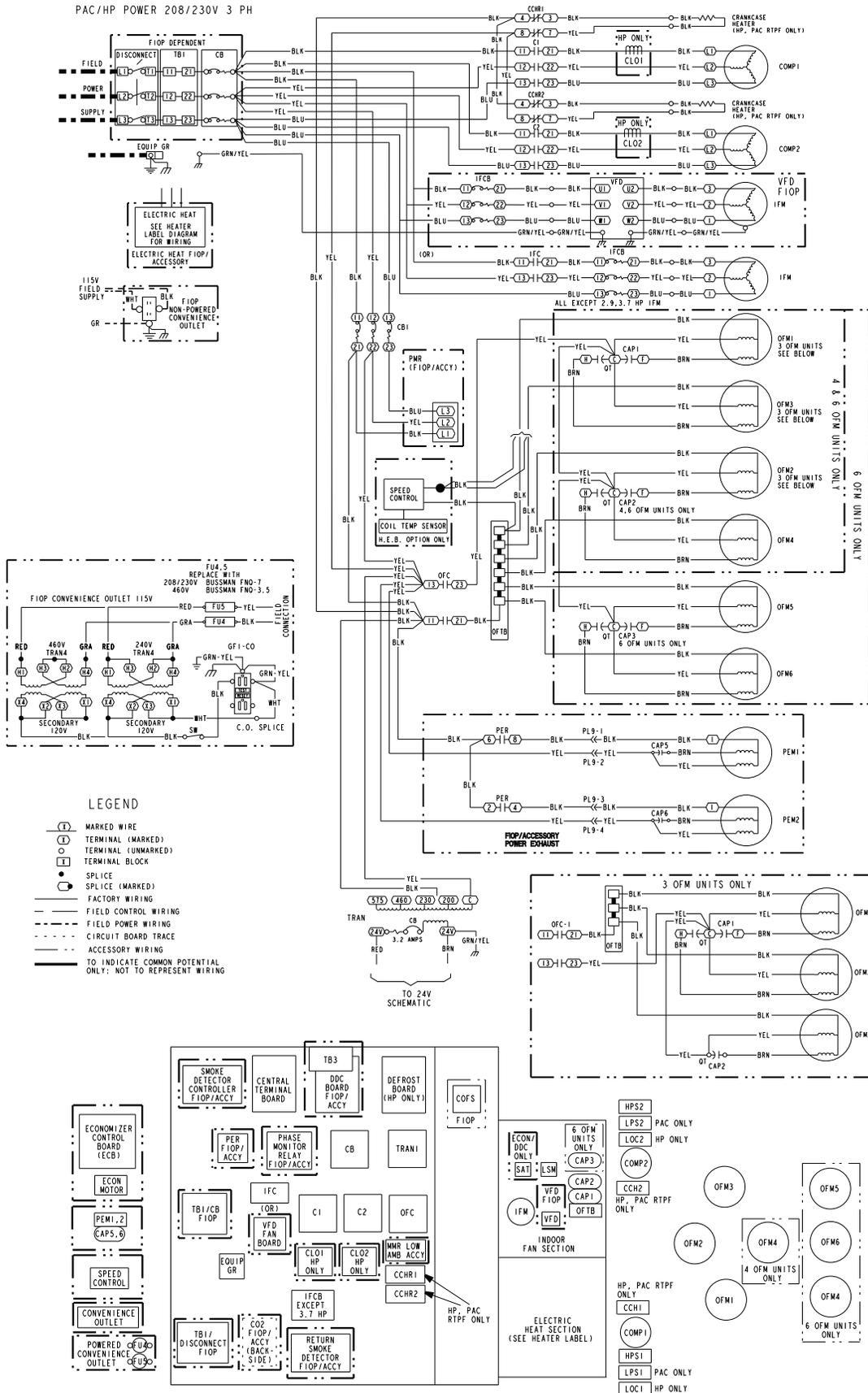
Fig. 52 - 50TCQ-D17 Power Wiring Diagram; 208/230-3-60
