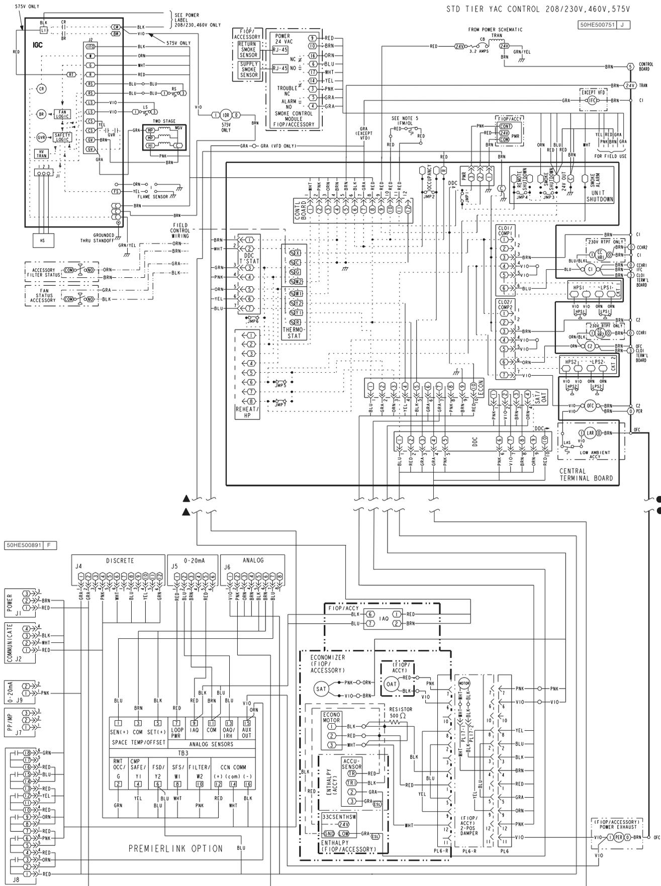
Fig. 58 - PremierLink™ Wiring Diagram
