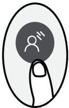
Appuyez sur ce bouton pour activer ou désactiver la fonction **Breeze Away** (Modification de la direction de l'air). Cette fonction évite que l'air ne soit soufflé directement sur les occupants et vous permet de vous détendre en douceur.
