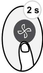
Appuyez sur le bouton FAN (VENTILATION) pendant plus de 2 secondes pour activer/désactiver la fonction SILENCE.
