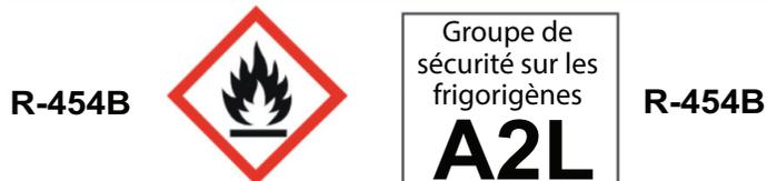
**REMARQUE** : Risque d'incendie. Frigorigène inflammable utilisé. Doit uniquement être réparé par du personnel d'entretien formé. Ne percez pas les conduites de frigorigène.
