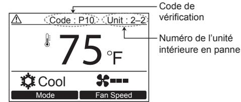
Si une erreur s'est produite dans le climatiseur, le code d'erreur et le numéro de l'unité intérieure apparaissent sur l'afficheur de la télécommande.
