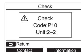
Si une erreur s'est produite dans le climatiseur, le code d'erreur et le numéro de l'unité intérieure apparaissent sur l'affichage de la télécommande.
