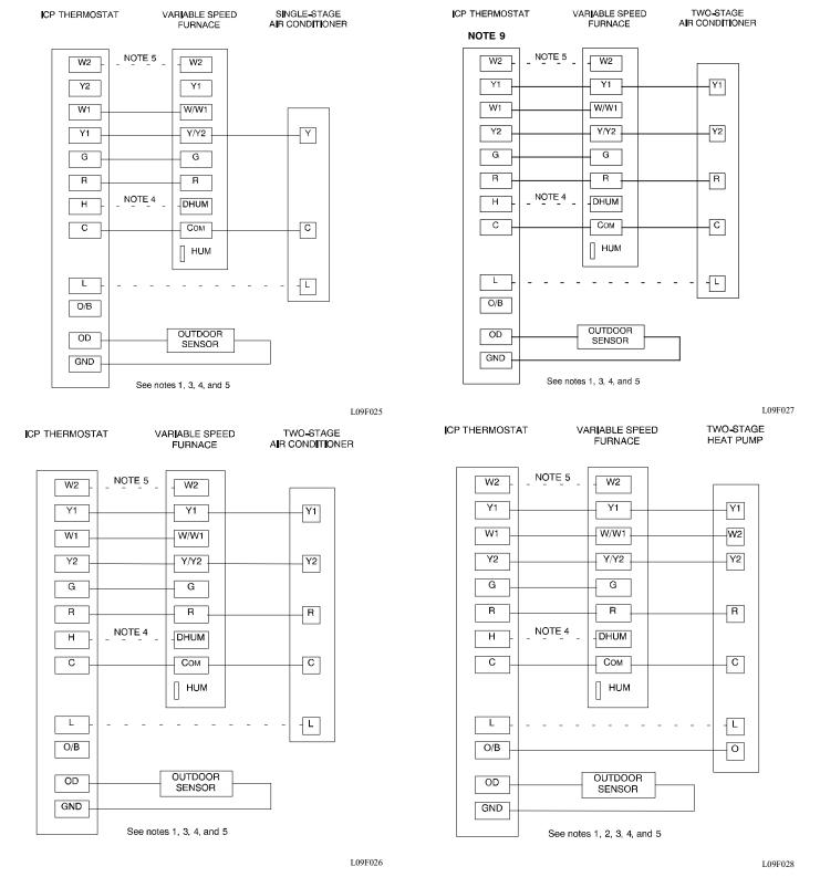
Fig. 39 – Thermostat Wiring Diagrams
