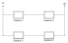
Figure 1 – Capteur à distance – Câblage en parallèle Remarques importantes concernant le câblage
