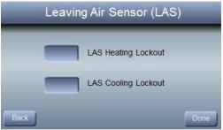
Verrouillage du chauffage du CAS 120 °F à 200 °F (49 °C à 93 °C); par défaut : 180 °F (82 °C)
