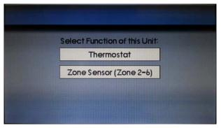
Une fois sous tension, le panneau de commande affiche les graphiques de chargement et invite l'installateur à sélectionner le mode de fonctionnement souhaité. Le panneau de commandes mural indique qu'il est désormais en train de rechercher les équipements intérieurs (« FINDING INDOOR EQUIPMENT »), puis les équipements extérieurs (« FINDING OUTDOOR EQUIPMENT »).
