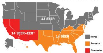
A partir del 1 de enero de 2015, entró en vigencia una nueva serie de normas mínimas de eficiencia. Conforme a estas normas nuevas, existen distintas normas mínimas de eficiencia para los sistemas de aire acondicionado en cada una de las tres regiones: norte, sureste y suroeste. La norma nacional mínima de eficiencia para las bombas de calor es 14 SEEN/8.2 HSPF.
