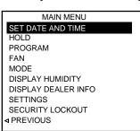
La mise en surbrillance de l'option MENU suivie d'une pression sur le bouton ENTRÉE affichera l'écran MAIN MENU (Menu principal). La mise en surbrillance de l'une des options à l'aide des boutons HAUT et BAS suivie d'une pression sur le bouton ENTRÉE affichera l'écran approprié pour cette option. Une pression sur le bouton GAUCHE affichera l'écran principal.
