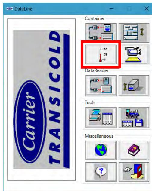
3. En la pantalla de calibración de sensores, haga clic en el botón Calibrar sensores de suministro o Calibrar sensores de retorno.
