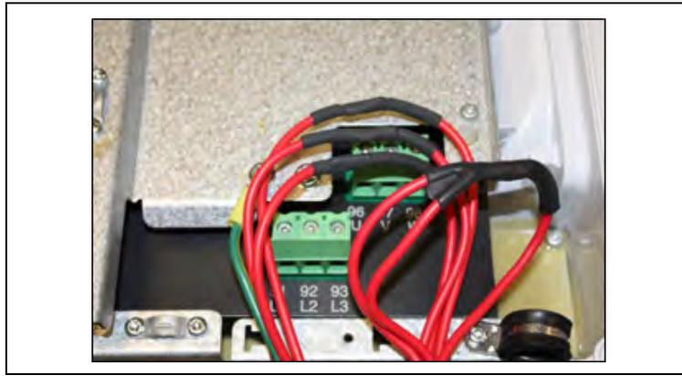
12. Instale las abrazaderas del arnés de cables y asegure los cables siguiendo las mejores prácticas para evitar daños.
