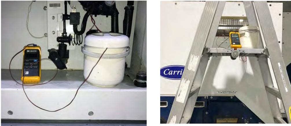
7. Una vez asegurada la estabilidad de la temperatura, sumerja los sensores en la mezcla de agua con hielo. Asegúrese de que los sensores no entren en contacto con las paredes ni con el fondo del recipiente, ni entre sí. Agite continuamente la mezcla de agua con hielo durante la calibración.
