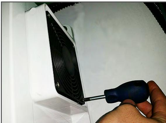
**Figura 7.22 Retiro del ventilador del VFD**
