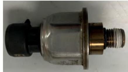
**Figura 7.14 Loctite 55 - Apriete el transductor**
