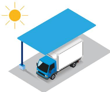
**STATIONNEMENT** Garez le véhicule à l'ombre. Ne stationnez pas votre véhicule dans une pente de plus de 10 % pour éviter une mauvaise vidange de l'eau.
