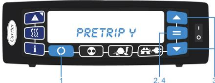
1. Pulse la tecla **FUNCIÓN** hasta que se muestre "PRETRIP!".
