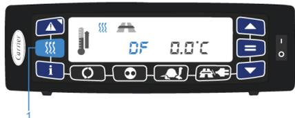
1. Pulse la tecla **DESCARCHE MANUAL** para iniciar un ciclo de descarche.
