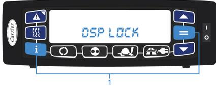
1. Para bloquear o desbloquear el mando cabina, mantenga pulsadas las teclas **ENTER&DATOS DEL EQUIPO** durante 5 segundos
