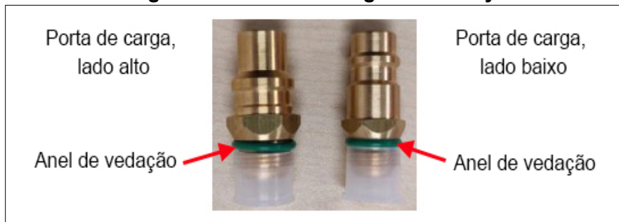
Figura 7.8 Portas de carga do R1234yf
