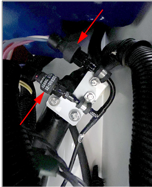
圖 3.27 蒸發器壓力传感器 - EPT (頂部) 和 SPT (底部)
