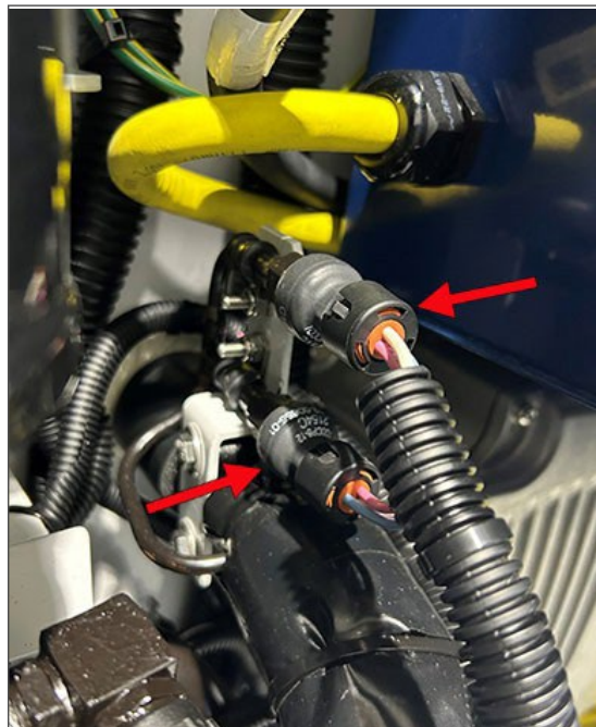
Figuur 3.28 Verdamperdruktransducers - EPT (onder) en SPT (boven)
