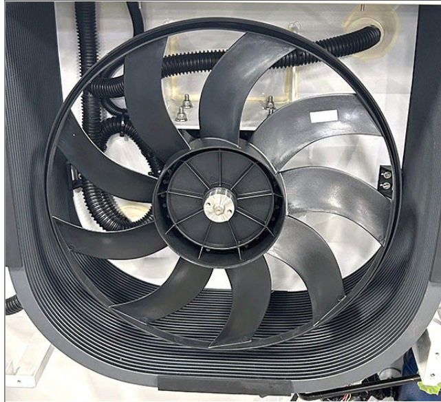
Afbeelding 3.9 Condensorspoel en ventilator (deksel verwijderd)
