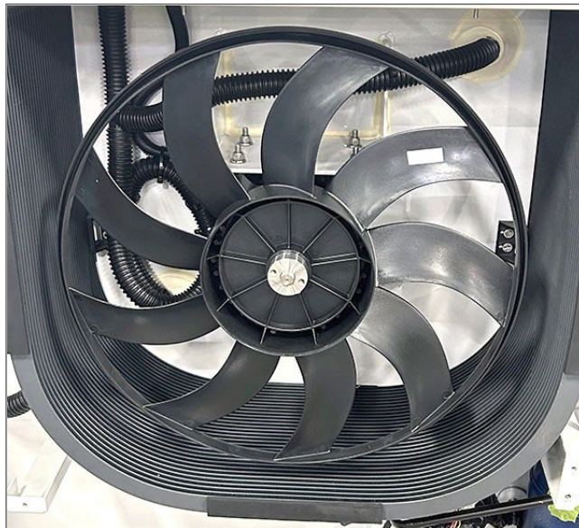
Figur 3.9 Kondensatorspole og ventilator (dæksel fjernet)
