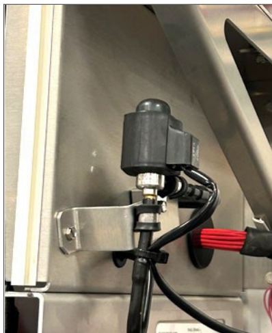
Figur 7.18 Elektronisk ekspansionsventil (EEV)
