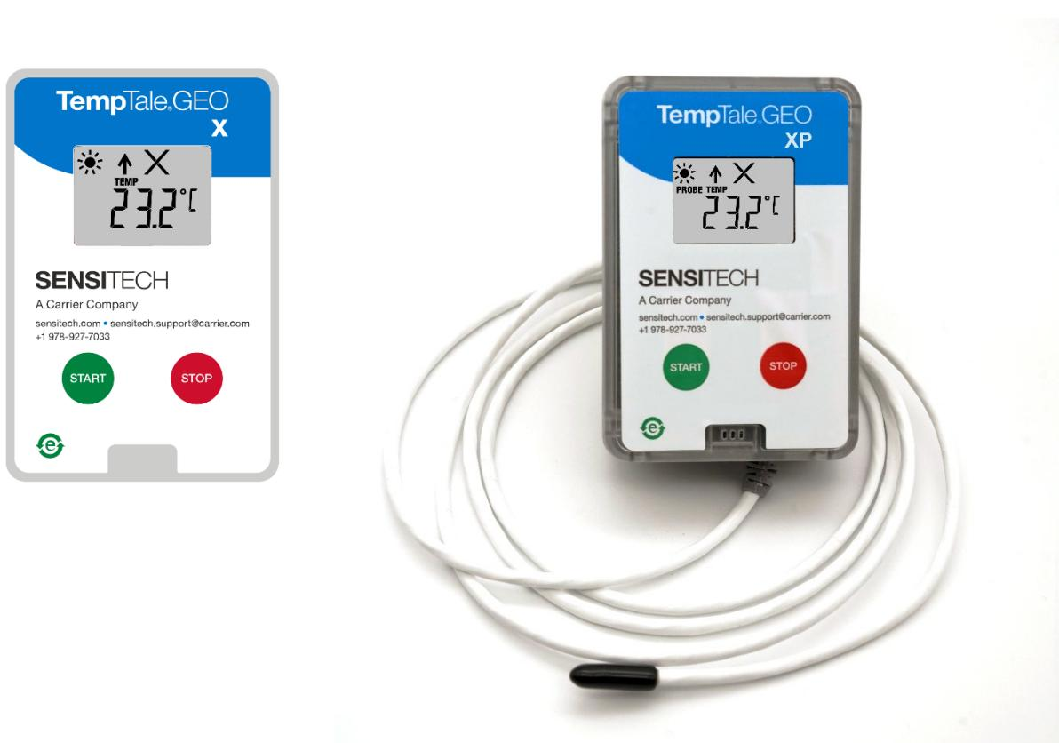
Los monitores IoT de temperatura en tiempo real **TempTale® GEO X, XE, XP y XEP** se pueden programar con retardos de inicio, intervalos de medición de temperatura, duración de recorridos y ajustes para alarmas de hardware de tiempo-temperatura.
