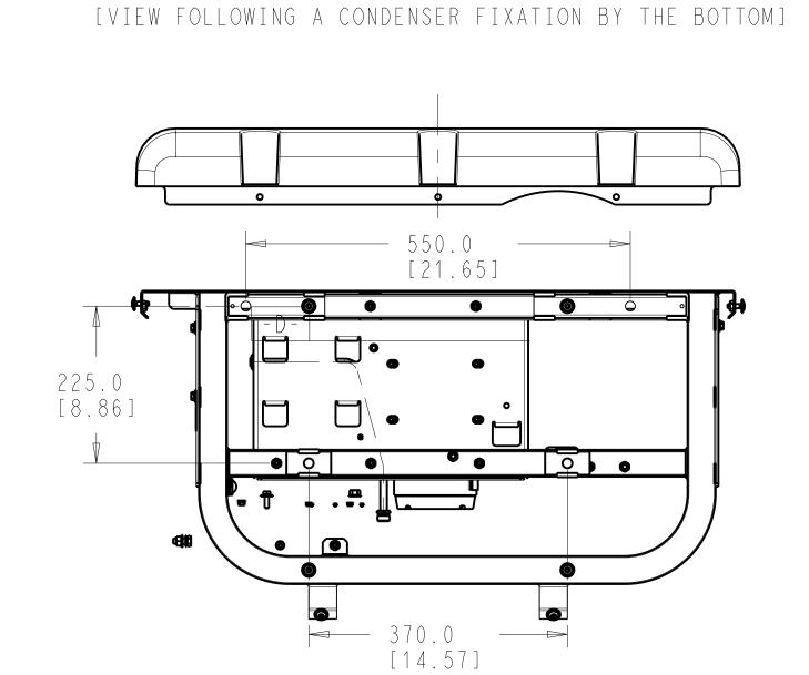
VUE SUIVANT A FIXATION DU CONDENSEUR PAR LE DESSOUS
