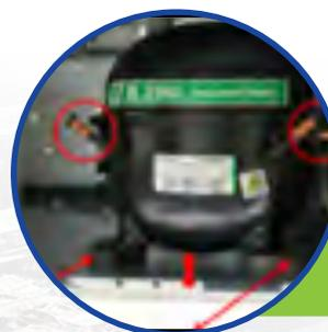
Cambio sencillo de compresor y otros componentes en el compartimento de la máquina
