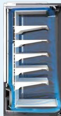
Multiestantes remoto con diseño de evaporador trasero que muestra la posición de la nueva tecnología de ventilador Carrier y la circulación de aire optimizada dentro del mueble para una temperatura de almacenamiento del producto mejor y homogénea.
