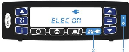
1. Posicione o interruptor de **FUNÇÃO/OPERAÇÃO** na posição de **FUNÇÃO** (I).
