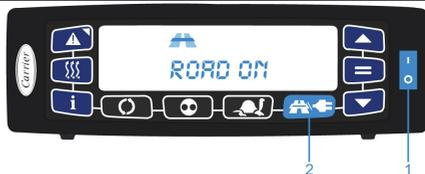
1. Posicione o interruptor de **FUNCIONAMENTO/PARAGEM** na posição de **FUNCIONAMENTO (RUN)** (1).
