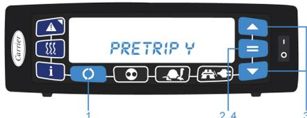
1. Drücken Sie die **FUNKTION**-Taste, bis "SELBSTDIAGNOSE" angezeigt wird.
