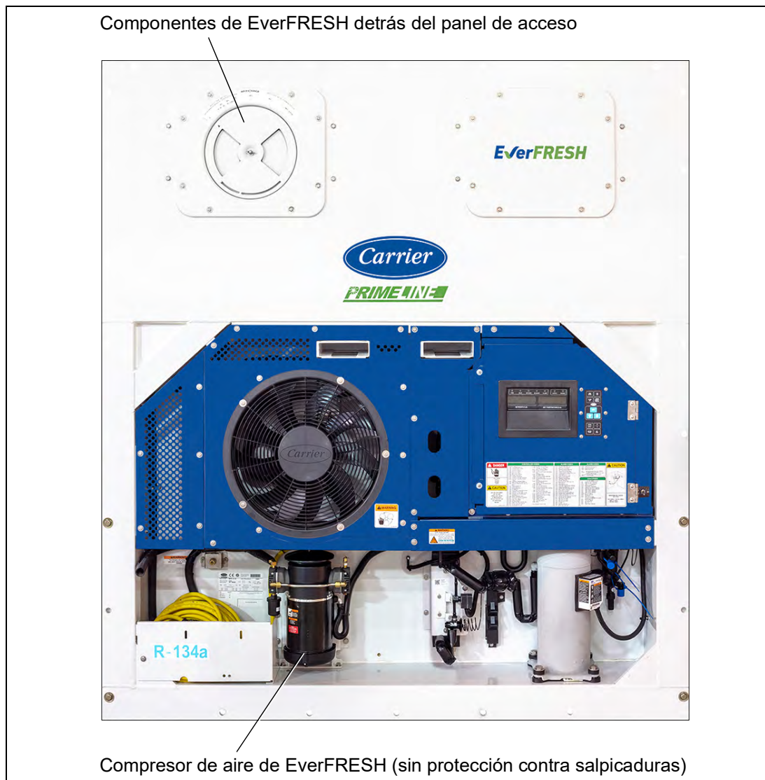
Figura 2.1 Unidad de refrigeración - vista frontal
