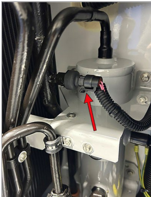
Figure 3.24 Transducteur de pression de refoulement (DPT)
