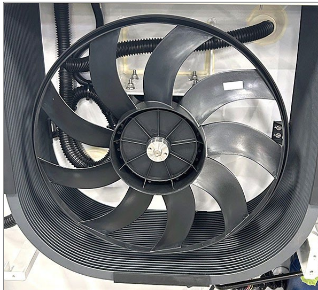
Figure 3.9 Serpentin du condenseur et ventilateur (couvercle retiré)
