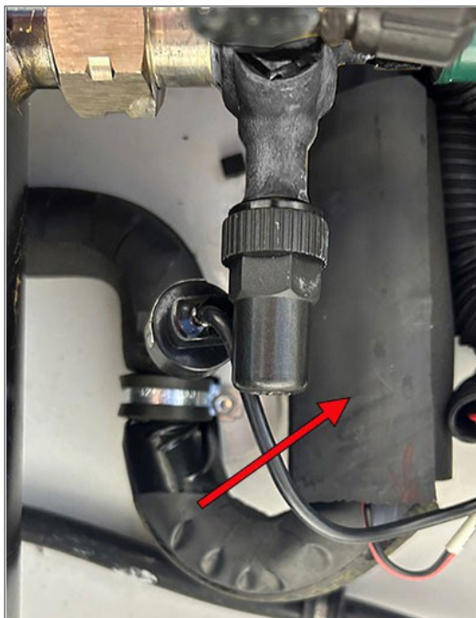
Figure 3.26 Capteur de température de l'économiseur (ECT)
