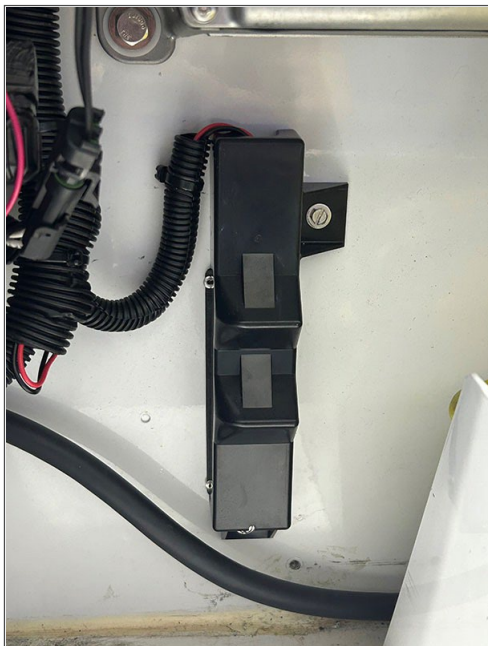
Figure 3.31 Capteur de température d'alimentation (STS) / Capteur d'enregistrement d'alimentation (SRS)
