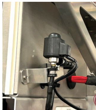
Figure 7.18 Détendeur électronique (EEV)
