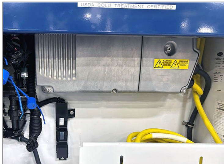
Figure 7.10 Variateur de fréquence (VFD)
