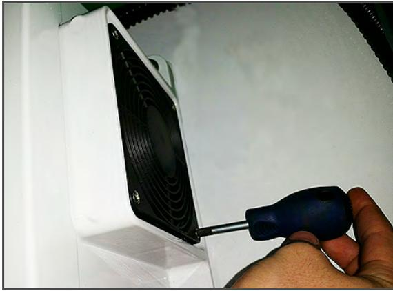
**Figura 7.22 Remoção do ventilador do VFD**
