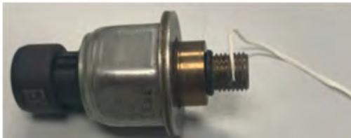
**Figura 7.14** Loctite 55 - Apertar transdutor
