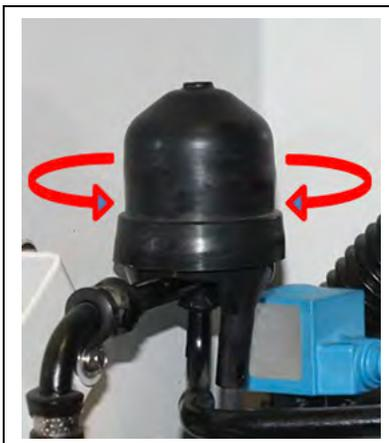
**Figura 7.18 Reentrâncias do corpo da válvula HPXV**
