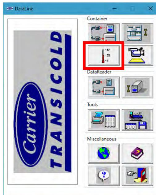
3. Na tela Calibração do Sensor, clique no botão Calibrar Sensores de Suprimento ou Calibrar Sensores de Retorno.
