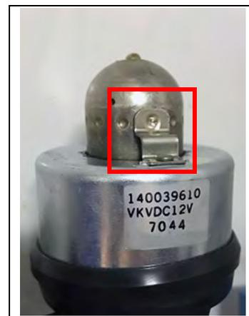
5. Aplique o ponto azul na parede lateral da unidade ao lado da serpentina, indicando que a bobina foi inspecionada e está assentada corretamente no corpo da válvula.
