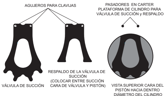
Fig. 7 — Pistón, válvula de succión y Posiciones de respaldo (06E)
