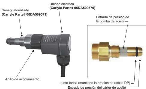
Fig. 17 — Interruptor de seguridad de presión de aceite
