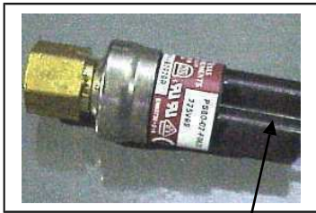
Pressostat HP / HP switch 291 / 399 psig (fils noirs / blackwires)
