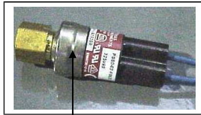
Pressostat BP / LP switch 4 / 14 psig (-) or 22 / 43 psig (+) (fils bleus / blue wires)
