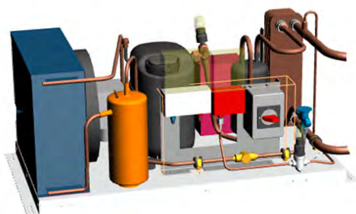
GROUPE DE SECOURS AUXILIARY CONDENSING UNIT DRUCKHALTESYSTEM
